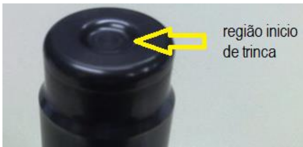
Fig. 5 – Região início da trinca
