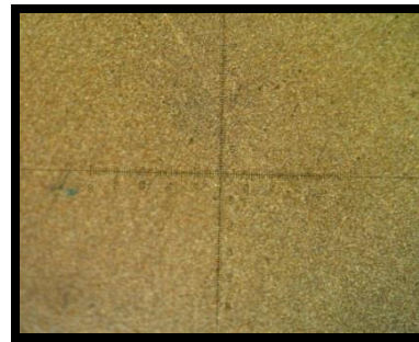
Fig. 8- Microestrutura do punção em M3:2
